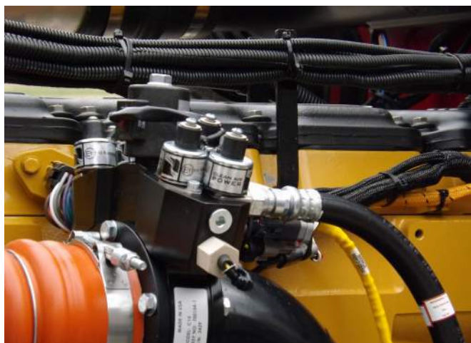
Sistema de inyección de gas natural
