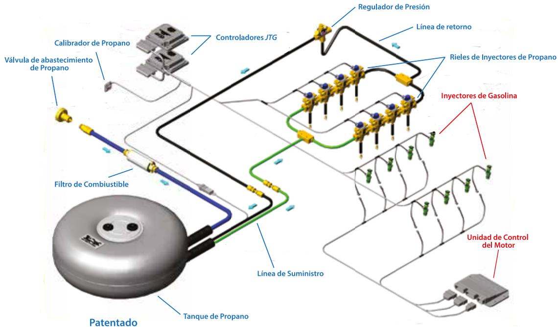
ICOM cuenta con varias opciones de tanque (el tanque toroidal se muestra arriba)
